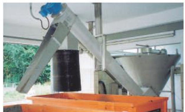
Šalinimo sraigtas gabena smėlį iš atskyrimo zonos į konteinerį.
