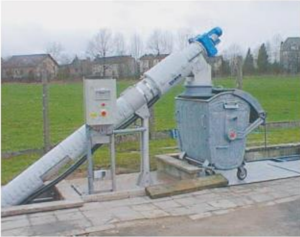
Lauke sumontuotas ROTAMAT® būgninis nešmenų šalinimo įrenginys Ro 1 su apsauga nuo šalčio.
