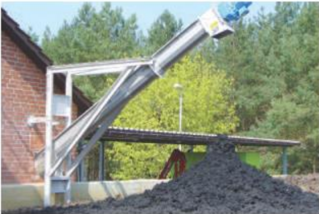
HUBER ROTAMAT® sraigtinis konvejeris Ro 8t po dumblo sausinimo sistemos.
