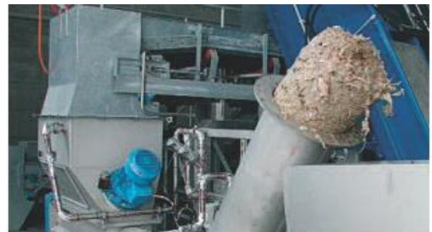
Gerai išplauti ir faktiškai bekvapiai nešmenys iš HUBER nešmenų plovimo presos WAP/SL, sutankinti iki 50% SM.
