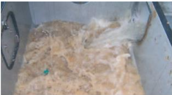
Didelė turbulencija plovimo talpoje sukantis rotoriumi.
