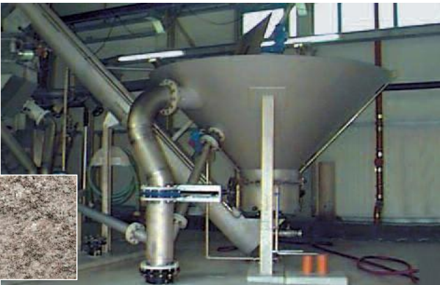
Išplautas smėlis iš COANDA smėlio plovimo įrenginio su < 3% iškaitinimo nuostoliu, dalelių dydis iki 10 mm, DR > 90%
