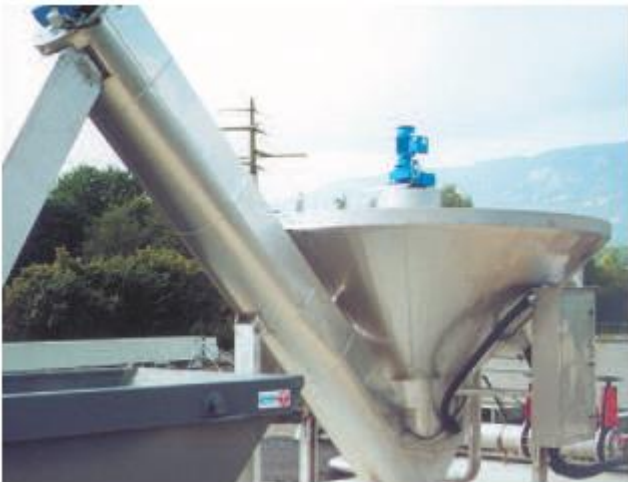
Novatoriška technologija: COANDA smėlio plovimo įrenginys RoSF 4, dydis 3, su apsauga nuo šalčio montavimui lauko sąlygomis.
