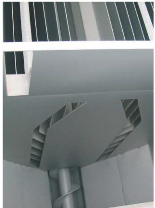
Kryžminio srauto plokštelių separatoriaus vaizdas.
