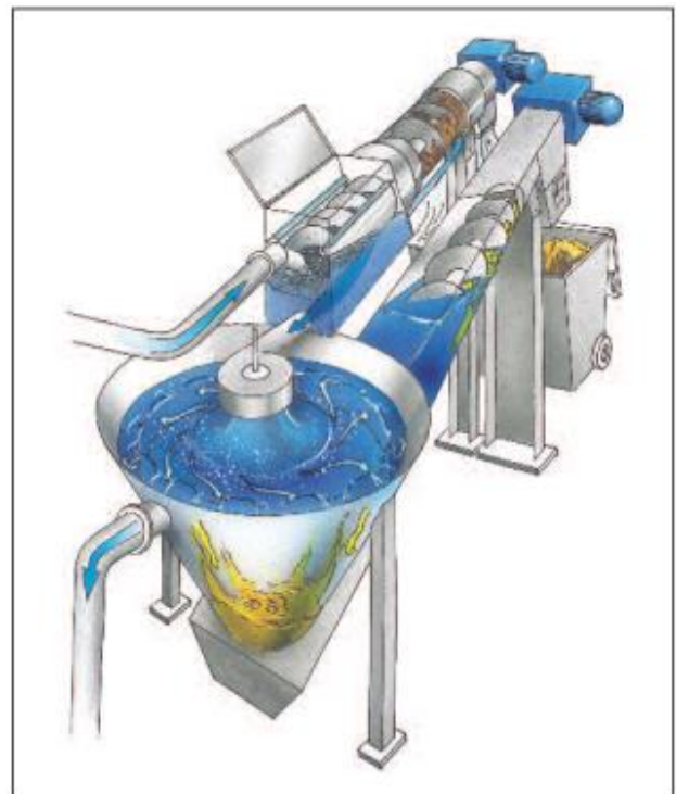
COANDA pilnutinio valymo įrenginio Ro 5C konstrukcijos vaizdas.
