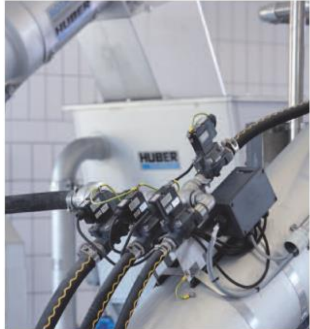
ROTAMAT® būgninis nešmenų šalinimo įrenginys su besisukančiu būgnu su integruota nešmenų plovimo sistema IRGA
