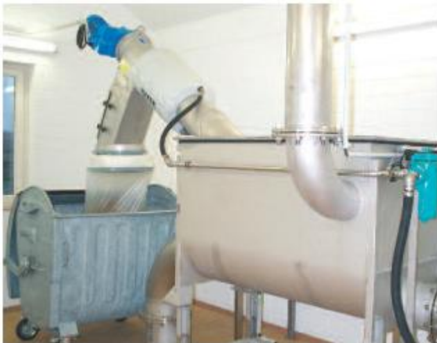
Rezervuare sumontuotas ROTAMAT® būgninis nešmenų šalinimo įrenginys su besisukančiu būgnu...
