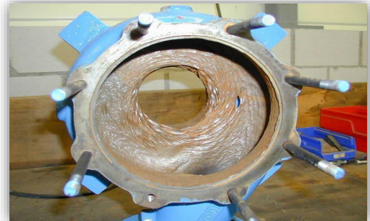
Susidėvėjęs siurblys dėl nuotekose esamo didelio smėlio kiekio
