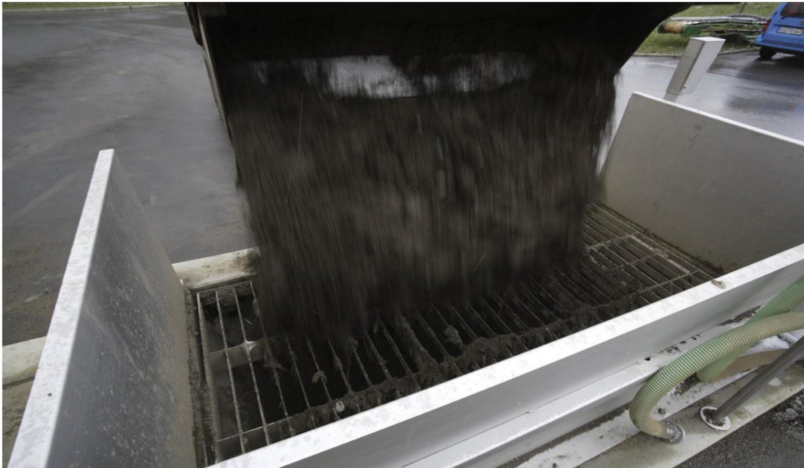
Priėmimo bunkeris su integruotu konvejeriu
