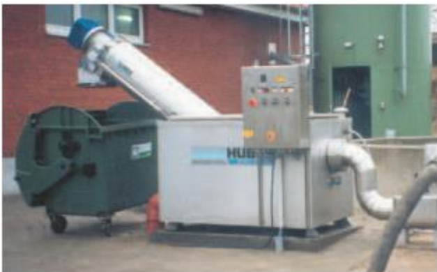
Šildomas ir izoliuotas ROTAMAT® septiko priėmimo įrenginys Ro 3.1 su ROTAMAT® būgniniu nešmenų šalinimo įrenginiu Ro 1.
