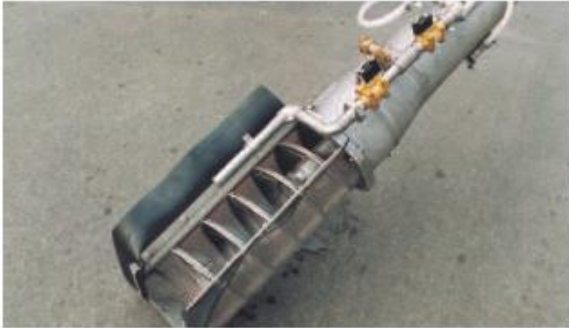
Integruota nešmenų plovimo sistema (IRGA). ROTAMAT® principas leidžia integruoti nešmenų plovimą tiesiogiai į apatinę kylančio vamzdžio dalį.
