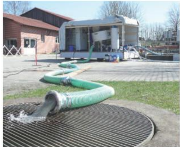
Kilnojamas ROTAMAT® diskinis dumblo tankinimo įrenginys RoS 2S, sumontuotas ant automobilio priekabos, paveikslu priekyje matomas švarus ištekantis filtrato vanduo.
