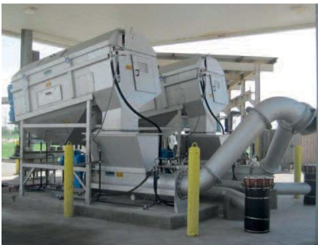
ROTAMAT® plovimo būgnas smėlio plovimui ir stambiųjų medžiagų atskyrimui (> 10 mm)
